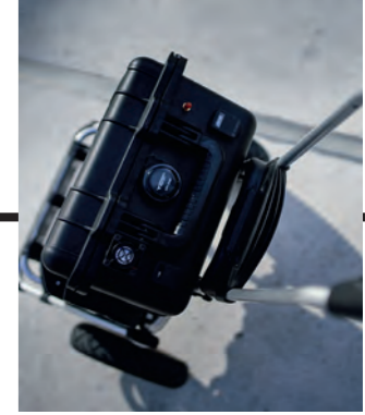
Die Walktest-Teams setzen Trolleys oder Rucksäcke ein, in denen starke Akkus die Test-Smartphones speisen.
